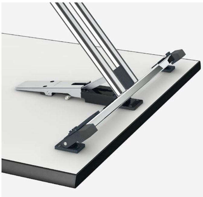
Stabilitätssystem STS: Klappmechanik mit Dreipunktlagerung und Stabilitätsdreieck
