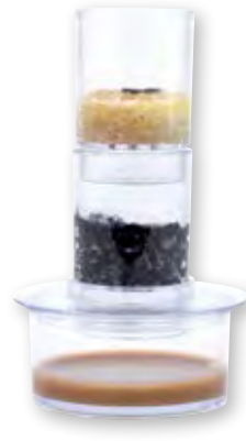
minimaler zweistufiger Filter mit Sand und Aktivkohle
