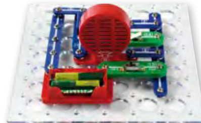
Experiment: Türklingel mit Druckschalter
